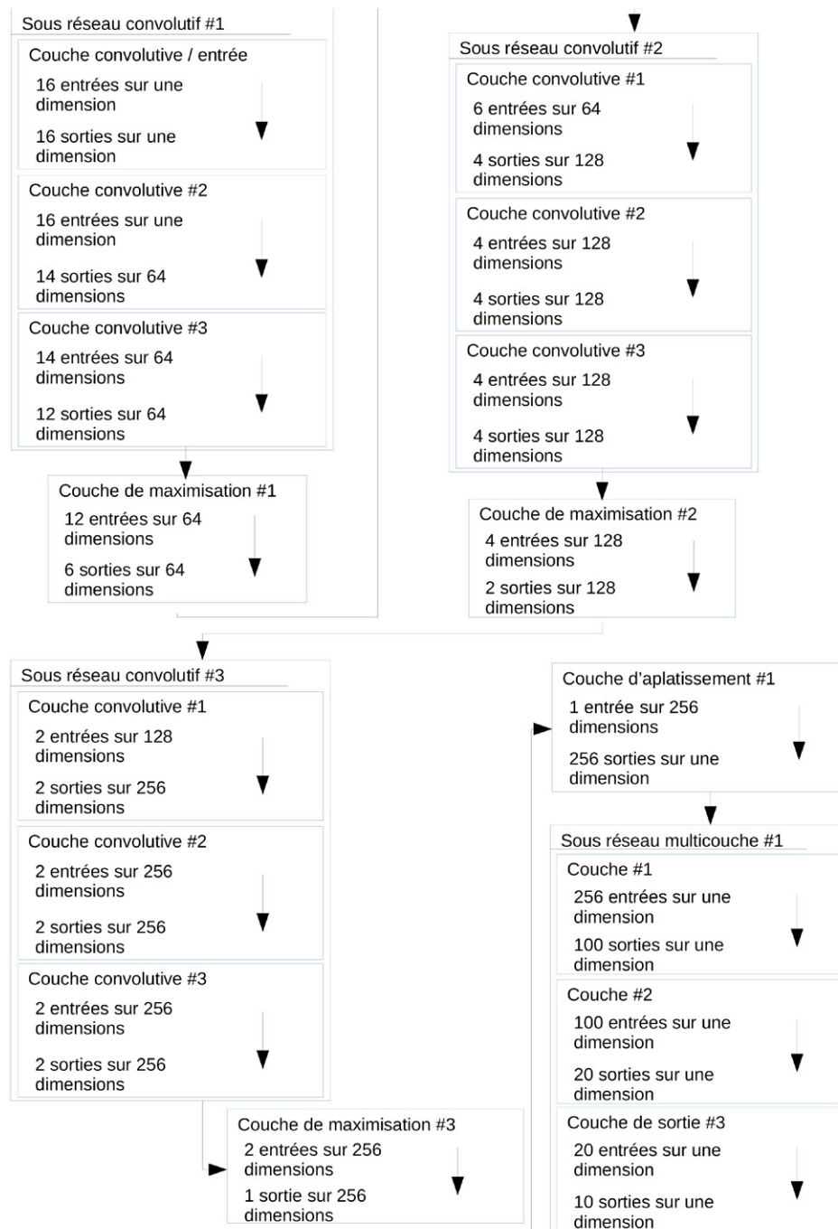
Fig. 2 : Architecture de notre réseau de neurones convolutionnels permettant de traiter 16 features en entrée via une série de couches de neurones convolutionnels cachés, entrecoupés de couches de mise en commun par maximisation, et d'obtenir en sortie une classification parmi 10 catégories (9 types d'attaques et 1 catégorie bénigne).
