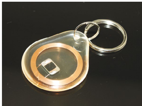
Fig. 2 : Un tag RFID type MIFARE Classic, sous la forme d'un porte-clés.
