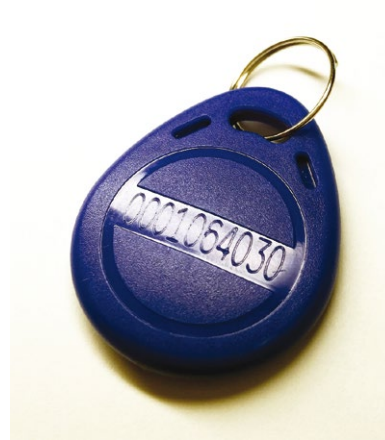
Fig. 1 : Un tag RFID fonctionnant à 125 kHz, norme EM4001.
