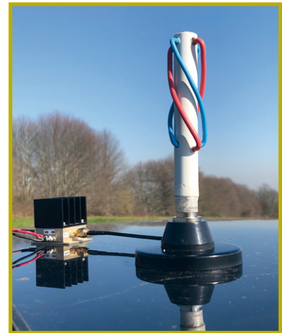
Fig.4 : Réception d'un signal Iridium avec une antenne QFH fabriquée avec du fil h07vu 2.5mm2 (Ø 0.9mm).
