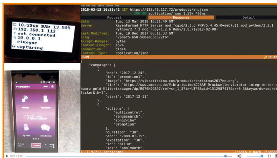
Fig. 1. Exemple d'utilisation du PiRogue en phase de capture de trafic (en haut à gauche) provenant de l'application Vibratissimo installée sur un smartphone Android de test (en bas à gauche). Le reste de l'écran est la sortie console.
