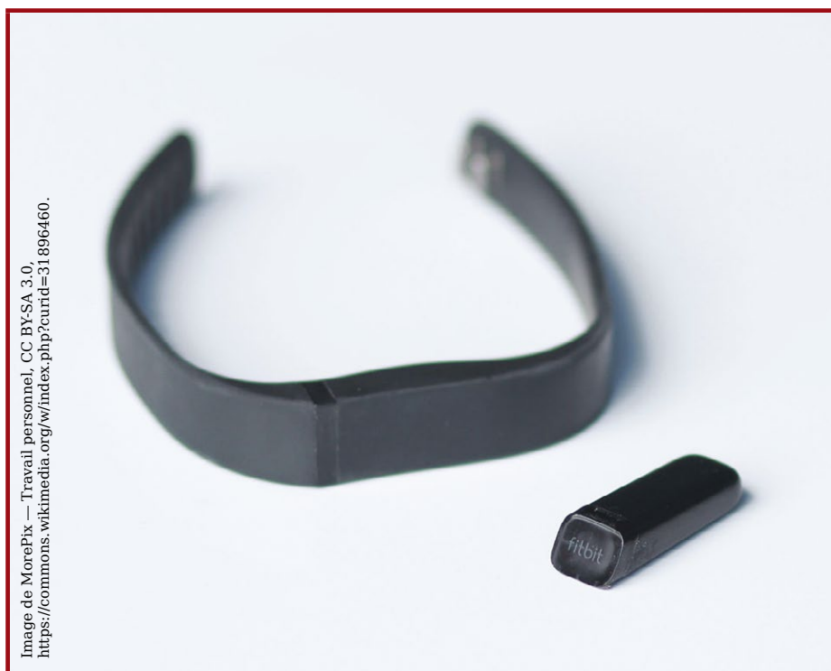
Figure 1 : Le bracelet Fitbit Flex est composé d'un bracelet en plastique (à gauche) dans lequel on place le traqueur même (en bas à droite).
