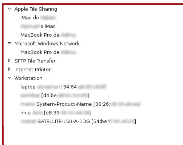
Figure 3 : Exemple d'identifiants visibles avec l'outil avahi-discover.
