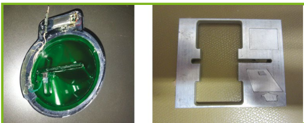
Fig. 1 : Exemples de fausses fentes d'insertion sur distributeur automatique.
