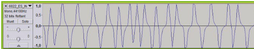
Fig. 8 : Fraction du signal analogique d'une piste 2 échantillonnée par le microcontrôleur.
