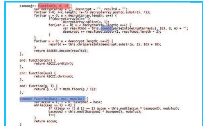
Figure 10 : Code Javascript pour le décryptage RSA
