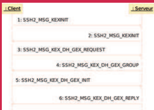
2 Processus d'échange de clés dans OpenSSH
