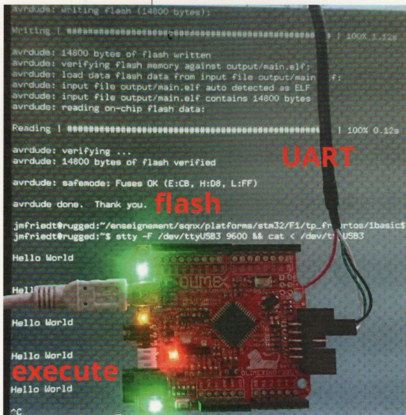
Figure 1 : Le microcontrôleur exécutant FreeRTOS avec 3 tâches, deux faisant clignoter les LED orange et verte de la carte Olimexino- 32U4, et la troisième communiquant un message sur le port de communication asynchrone.
